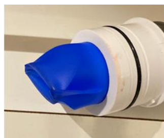
Zawór wywinięty nieprawidłowo w drugą stronę
